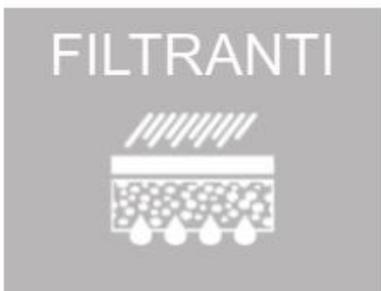
La Serie FILTRANTI è realizzata con impasto speciale a granulometria maggiorata. Tale miscela ne incrementa la capacità filtrante e favorisce il passaggio dell'acqua verso la falda acquifera senza l'utilizzo di ausilii per la raccolta dell'acqua superficiale.
