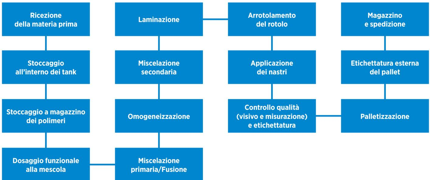
Figura 1 • Flow diagram per la descrizione processo produttivo.
