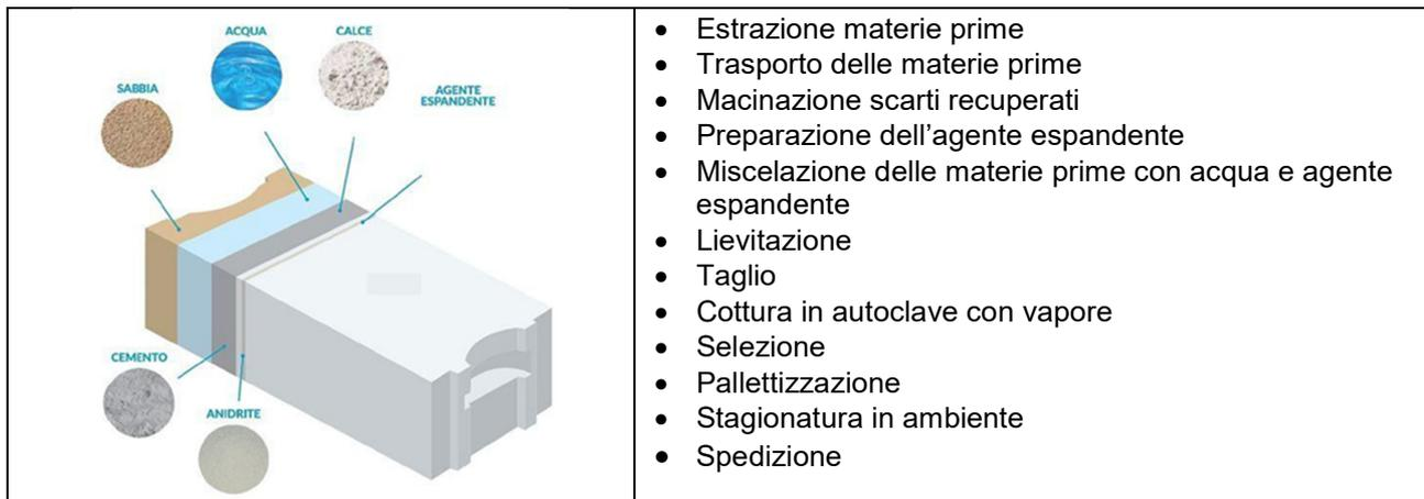
La sabbia silicea macinata viene miscelata in un mixer con ossido di calcio calcico, gesso (anidrite), cemento portland, materiali di scarto provenienti dal processo, pasta di alluminio (in funzione della densità desiderata), fino a quando diventa una sospensione acquosa. La miscela viene poi versata in stampo per colata, denominato cassero dove si solidifica.
