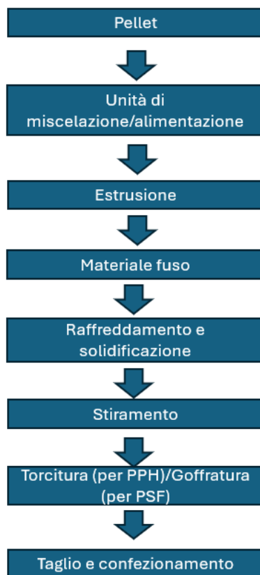
Figura 4: Schema ciclo produttivo fibra polimerica PPH e PSF.
