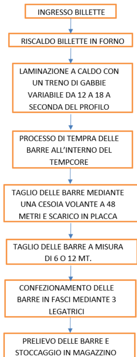
Figura 3: Schema ciclo produttivo del tondo di IMI SUD LAMINATI.
